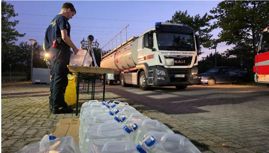
Abbildung 3.14.3: Sattelzugmaschine des Katastrophenschutzes mit Trinkwassertankaufleger neben einer Trinkwasserzapfstelle zur Ausgabe von Trinkwasser bei ausgefallenen Leitungsnetzen; Foto: NLBK
