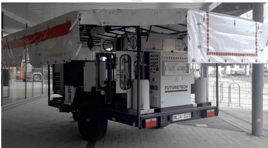
Abbildung 3.14.6: sog. Trinkwasserbeutelabfüllanlage mit nachgelagerter Trinkwasseraufbereitungsanlage zur Bereitstellung abgefüllten, aufbereiteten Trinkwassers an die Bevölkerung bei beeinträchtigter Trinkwasserversorgung; Foto: MI
