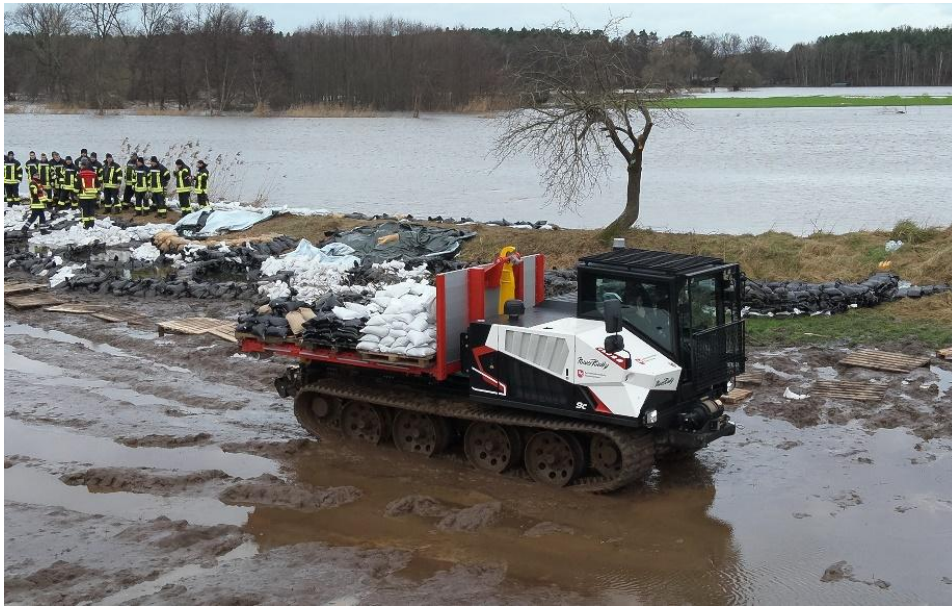
Abbildung 3.14.1: Kettengetriebenes Logistikfahrzeug eingesetzt beim Sandsacktransport im durchweichenden Gelände zur Deichsicherung während Hochwasserlage 2023/2024; Foto: NLBK
