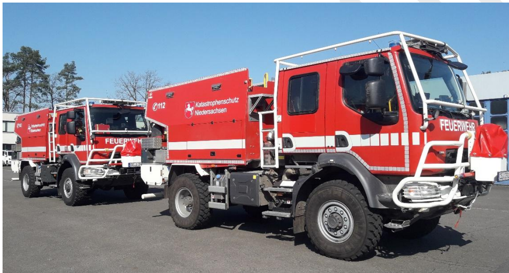
Abbildung 3.14.4: Spezialisierte Tanklöschfahrzeuge für die Vegetationsbrandbekämpfung (sog. CCFM 3000); Foto: MI
