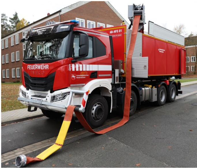
Abbildung 3.14.5: Hochleistungsförderpumpensystem zur Löschwasserförderung oder für Lenzstätigkeiten bei Überflutungen; Foto: NLBK
