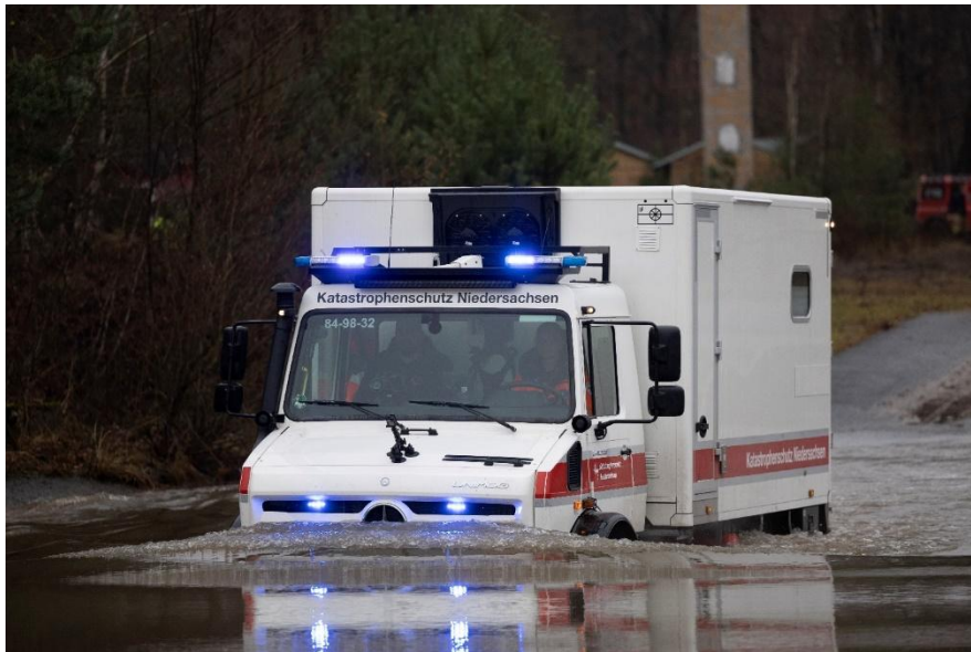
Abbildung 3.14.7: Sog. Krankentransportwagen geländegängig für die Sicherstellung der Notfallversorgung und des Patiententransports in Schadensgebieten mit stark eingeschränkter Befahrbarkeit, auch bei Überflutung; Foto: NLBK
